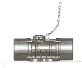
Рис. 3 Противовыбросовое устройство вибрационного двигателя
